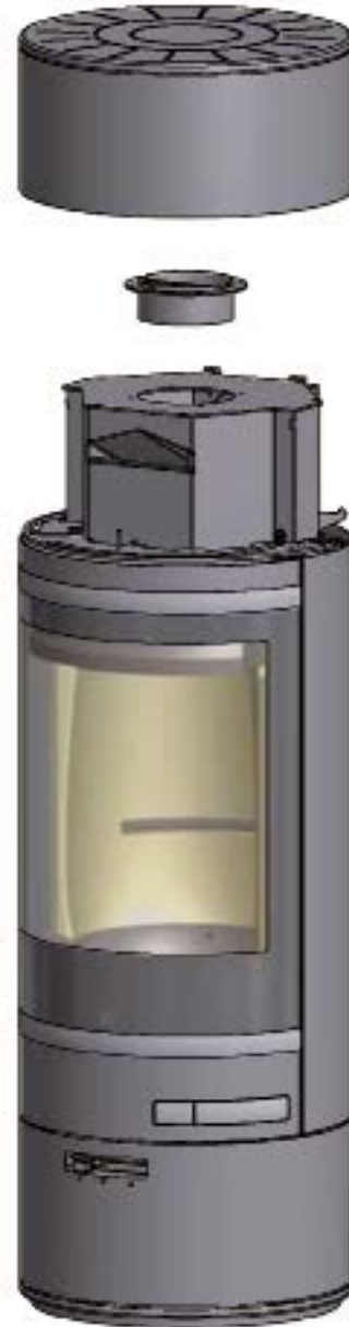
Keraminio tarpiklio sumontavimas ant jungiamosios dalies
